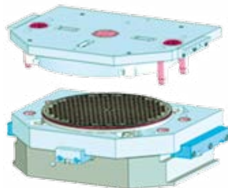
Vue 3D du moule d'injection-compression, 413 empreintes
